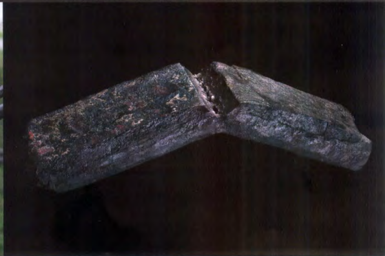
8 und 9 Ausschmieden der Luppe: Phil und Johanna schlagen zu 11 Ergebnis: Unser Eisenbarren – vorbereitet für eine zweite Faltung
